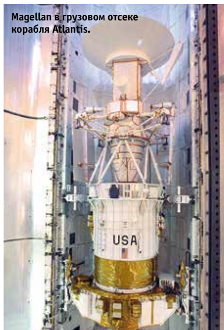
Выведение AMC Magellan с разгонным блоком IUS (Inertial Upper Stage) из грузового отсека шаттла.
